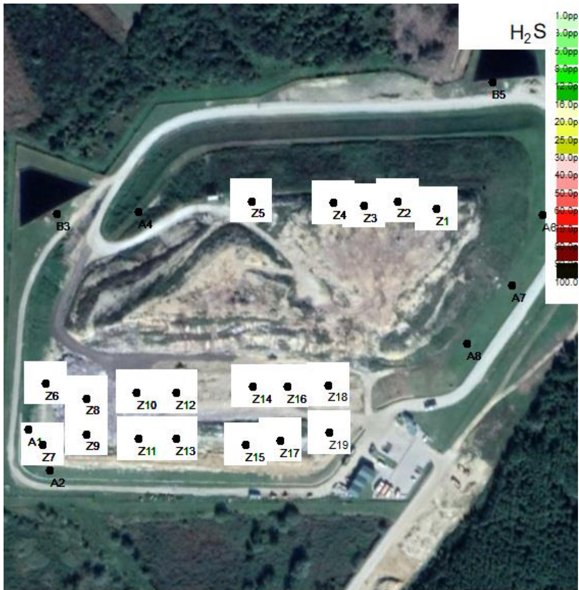
Slika 5: Koncentracije H 2 S u ppm po odzračnicima na odlagalištu Piškornica - Koprivnicki Ivanec.
