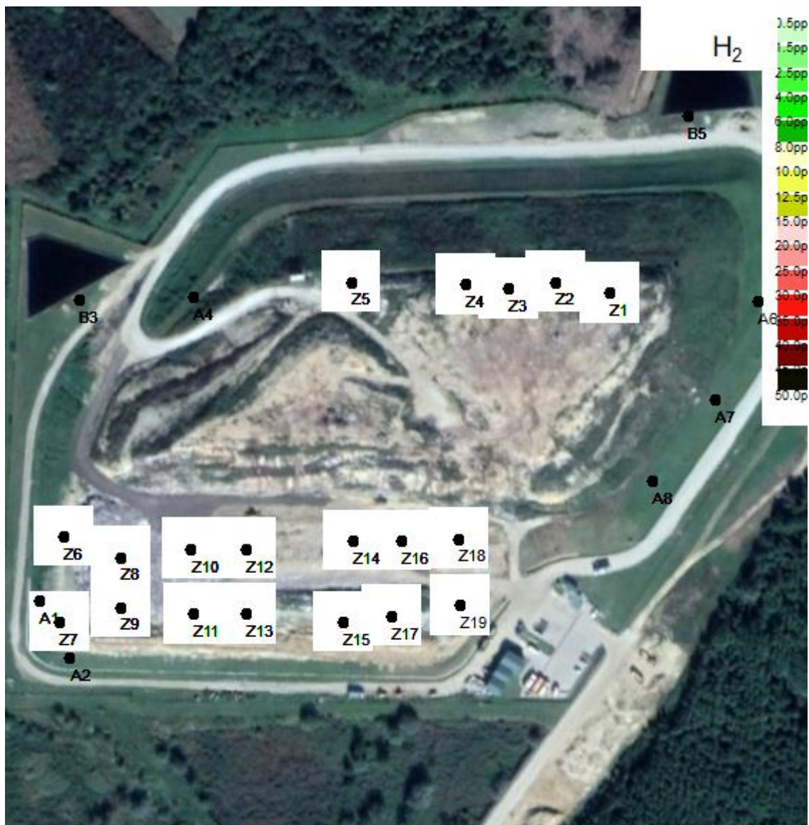
Slika 4: Koncentracije H_2 u ppm po odzračnicima na odlagalištu Piškornica - Koprivnicki Ivanec.
