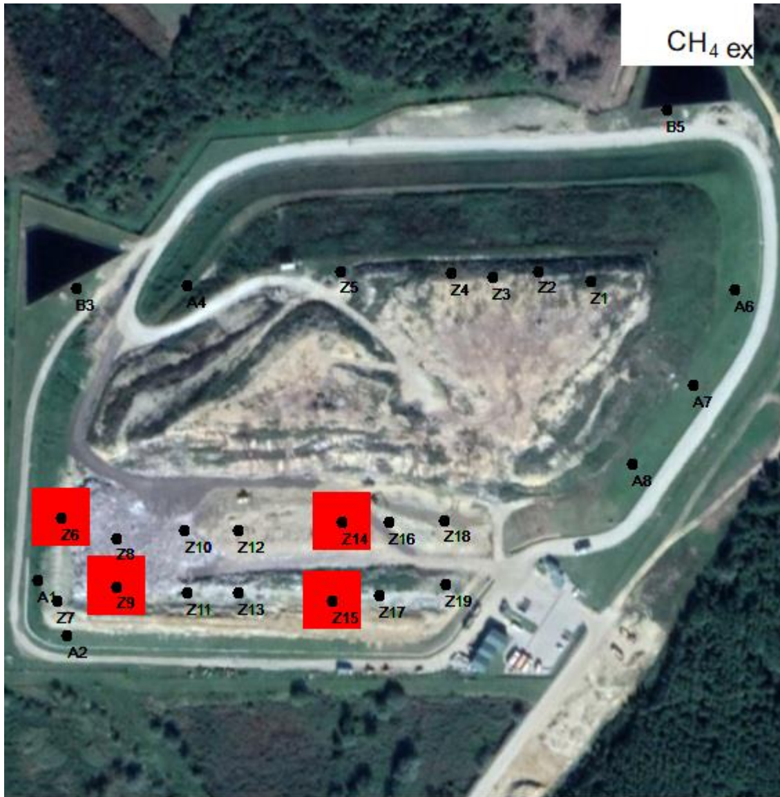
Slika 6: Odračnici na kojima postoji opasnost od eksplozije zbog eksplozivne koncentracije CH 4 (5 – 15 vol %) na odlagalištu PIŠKORNICA - KOPRIVNIČKI IVANEC.
