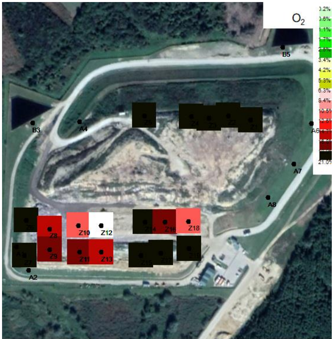
Slika 3: Koncentracije O_2 u vol. % po odzračnicima na odlagalištu
