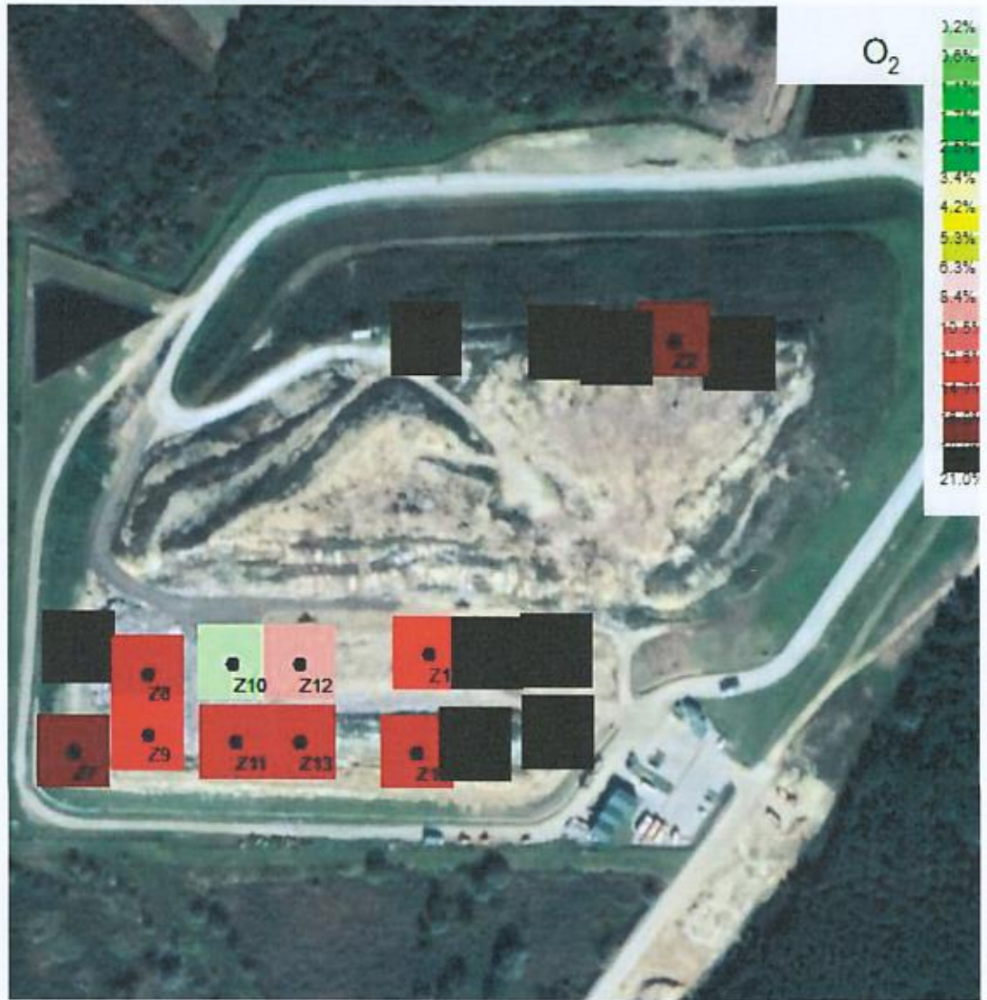
Slika 3: Koncentracije O 2 u vol. % po odražnicima na odlagalištu PIŠKORNICA - KOPRIVNIČKI IVANEC.
