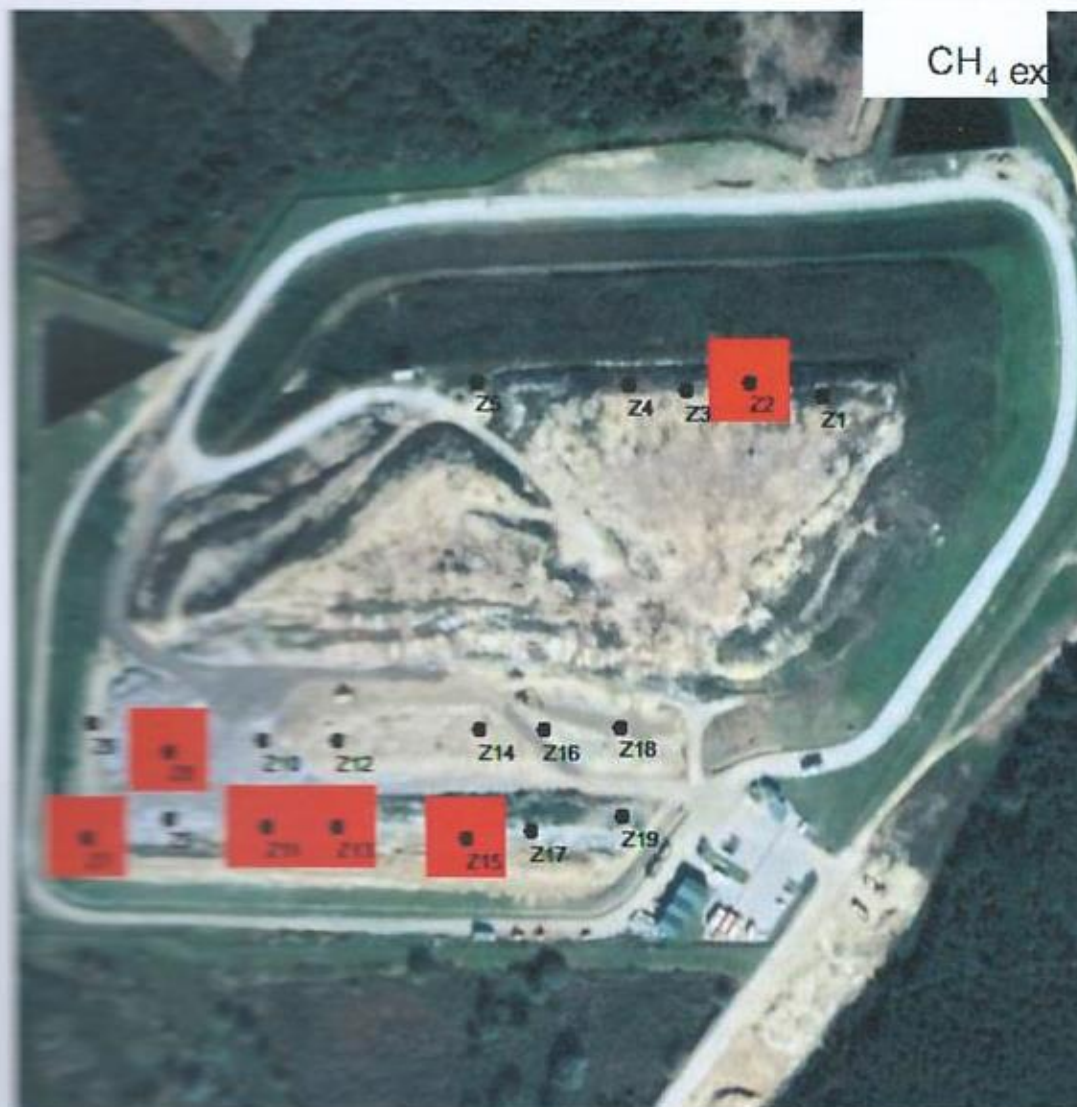
Slika 6: Odbiračnici na kojima postoji opasnost od eksplozije zbog eksplozivne koncentracije \text{CH}_4 (5 – 15 vol %) na odlagalištu PIŠKORNICA - KOPRIVNIČKI IVANEC.
