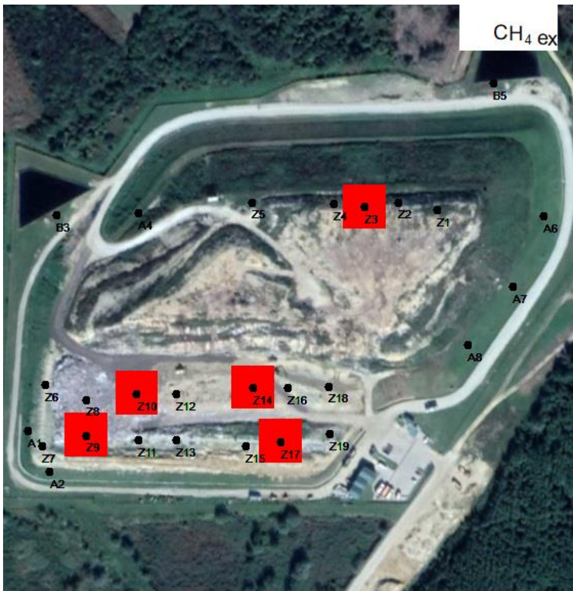
Slika 6: Odračnici na kojima postoji opasnost od eksplozije zbog eksplozivne koncentracije CH 4 (5 – 15 vol %) na odlagalištu PIŠKORNICA - KOPRIVNIČKI IVANEC.
